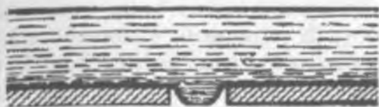
23-rasm. Ho'llamovchi suyuqlik kichik teshiklardan oqmaydi
