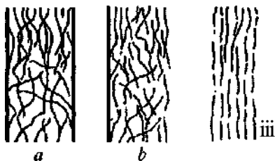
115- rasm. Tolaga shakl berishda chiziqli molekularning oriyentatsiyalanishi.
