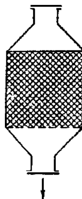
28- rasm. Ekzotermik jarayonlar uchun shaxta tipidagi ideal siqib chiqarish reaktori.
