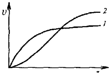
53- rasm. Oddiy reaksiya (1 - egri chiziq) va avtokatalitik reaksiya (2 - egri chiziq) paytida vaqt o'tishi bilan reaksiya tezligining o'zgarishi.
