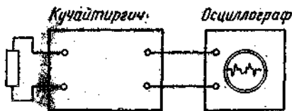
283- расм. Электр флуктуацияларини кўзатиш схемаси.
