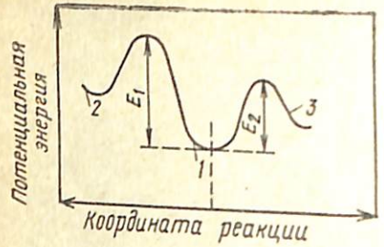
Рис. 1.1. Изменение потенциальной энергии при протонировании пропена: 1 — исходная система \text{CH}_3\text{CH}=\text{CH}_2 + \text{H}^+ ; 2 — первичный карбокатион \text{CH}_3\text{CH}_2\text{CH}_2^+ ; 3 — вторичный карбокатион (\text{CH}_3)_2\text{CH}^+ . E_1 и E_2 — энергии активации образования первичного и вторичного карбокатионов соответственно.
