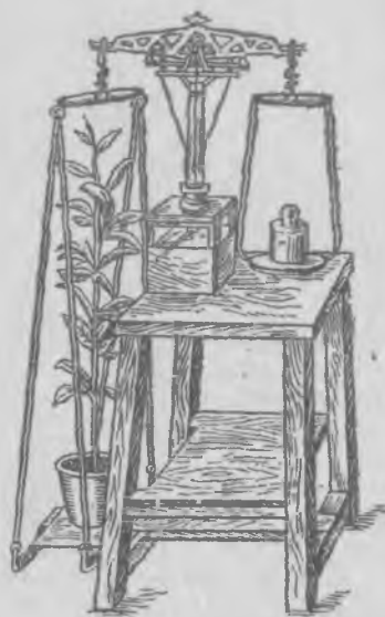
34-расм. Транспирация жадаллигини белгилайдиган тарози.
